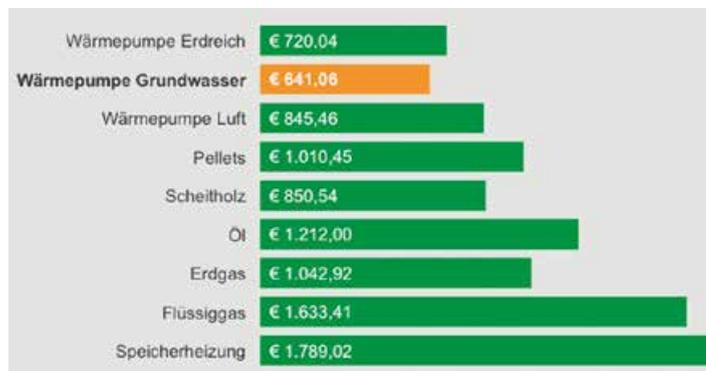
*Sanierter Altbau: 130 m<sup>2</sup>; Heizleistung 8,25 kW; gut gedämmt; Radiatorenheizung*
